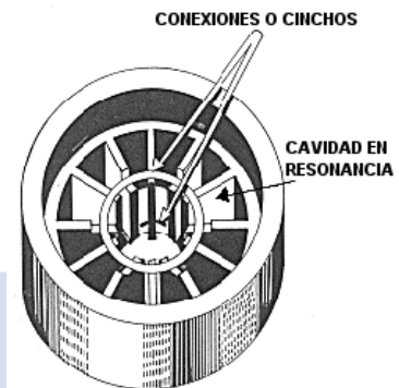
Bloque de ánodo típico con aspas
